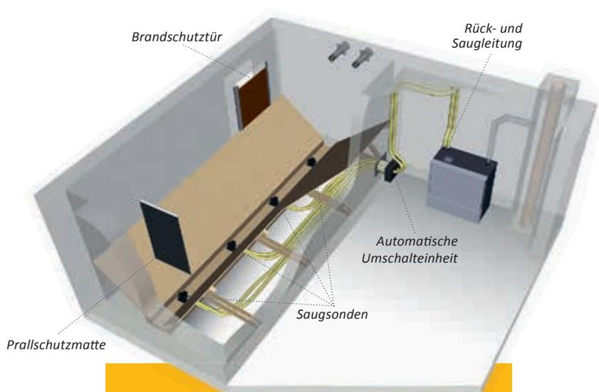
Mit den Saugsonden können nahezu alle Räume für ein Pelletslager genutzt werden, auch wenn sie verwinkelt sind.
