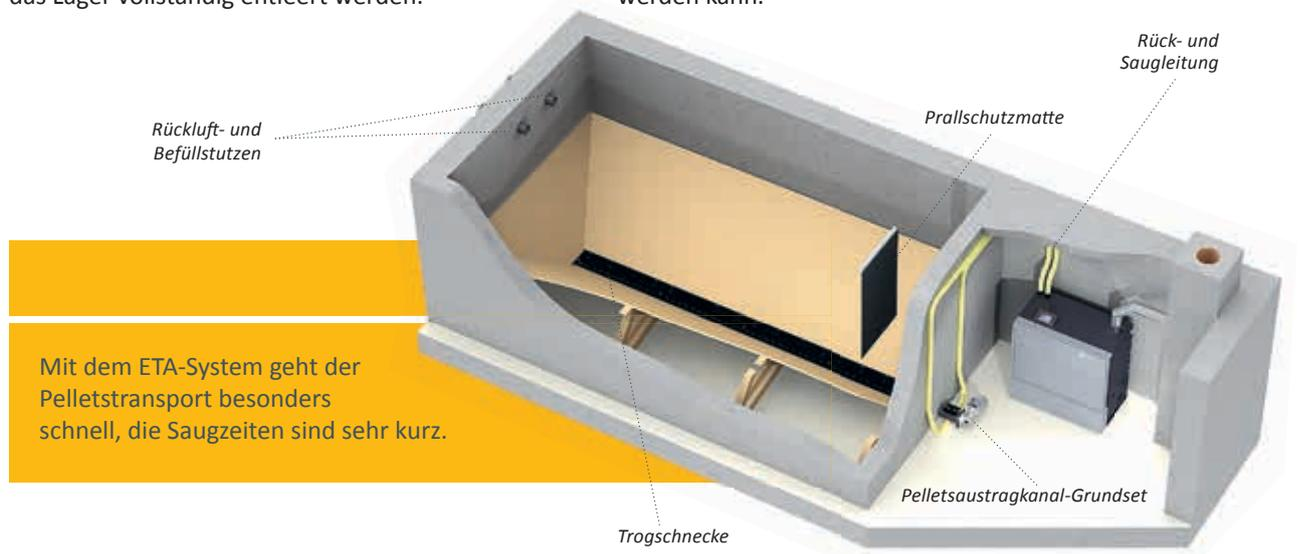
Mit dem ETA-System geht der Pelletstransport besonders schnell, die Saugzeiten sind sehr kurz.
