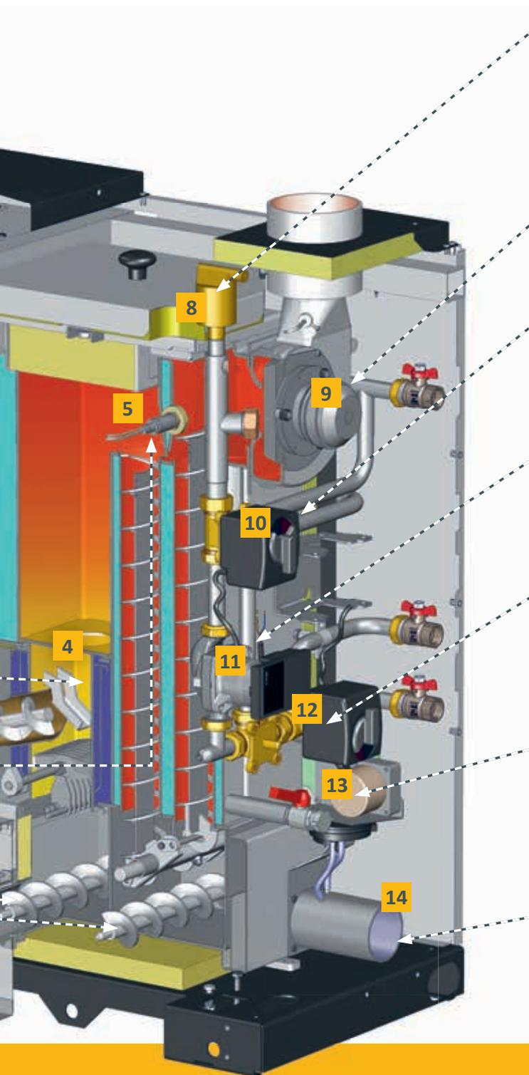
**8 Sicherheitsarmaturen:** Vor einem Überdruck im Kessel schützen ein Sicherheitsventil und ein elektronischer Drucksensor. Auch ein automatischer Schnellentlüfter ist integriert, der unerwünschte Luft aus dem Heizwasserkreislauf entfernt. Eine thermische Ablaufsicherung braucht der Kessel nicht, da sich nie so viel Brennstoff im Kessel befindet, dass es zu einer Überhitzung kommen könnte.
